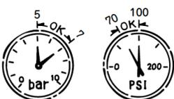
Das Werkzeug ist für einen Druckluftbereich von 70 psi bis 100 psi (5 bis 7 bar) vorgesehen. Der Druck sollte entsprechend der zu befestigenden Werkstücke eingestellt werden. Das Werkzeug darf niemals bei einem Betriebsdruck über 120 psi (8,3 bar) verwendet werden.
