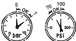
Das Werkzeug ist für einen Druckluftbereich von 70 psi bis 100 psi (5 bis 7 bar) vorgesehen. Der Druck sollte entsprechend des zu befestigenden
